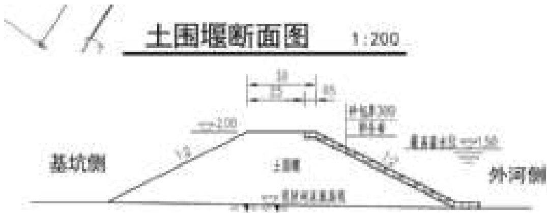
图1-2 内河围堰断面图
